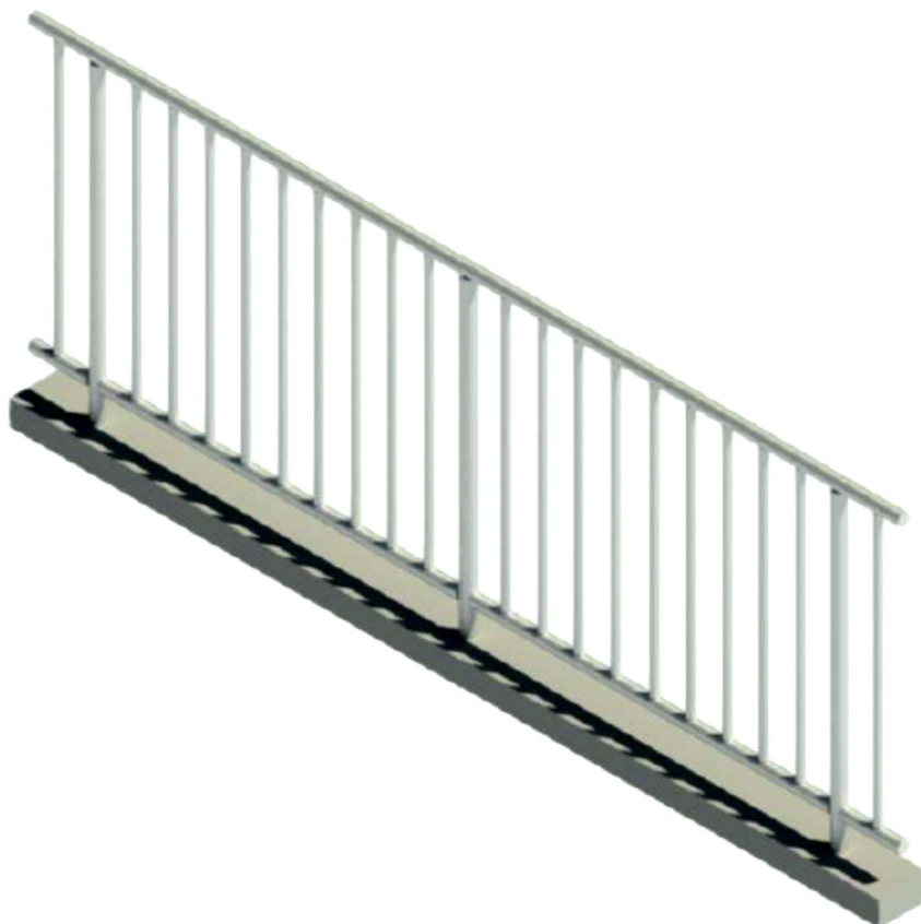
Figura 5 - Imagem 3D do guarda-corpo tubos verticais. Fonte: SUDECAP. Nota: Desenho elaborado em 24/03/2023.
